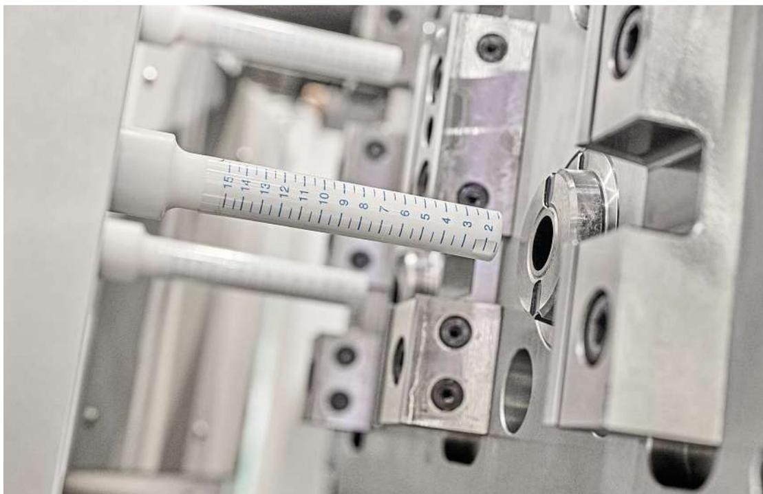
Les étiquettes, dont l'épaisseur est de 57 µm, doivent être positionnées le plus précisément possible dans les empreintes.
