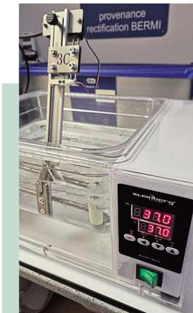
Dispositif de mesure de flexion 3 points développé pour suivre la production des arcs.
