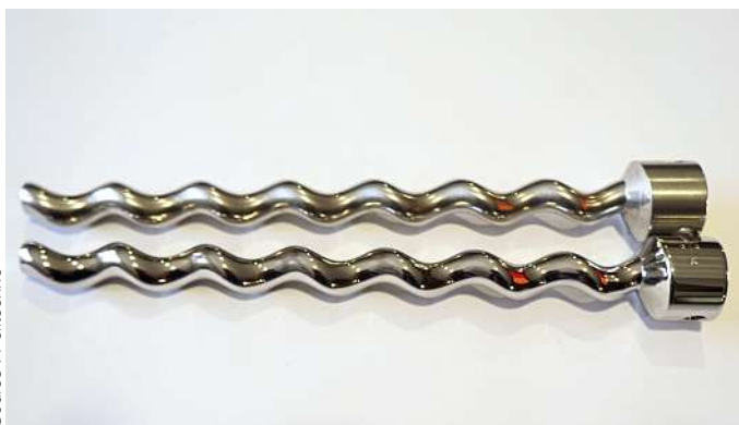
Pièce en inox 316L usinée puis polie en tribofinition haute énergie voie sèche (Ra 0,022 microns).
