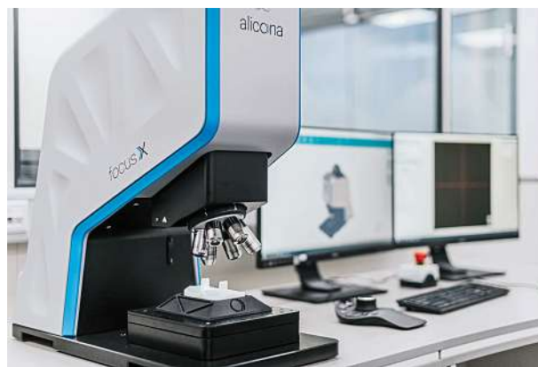
Le FocusX mis en œuvre pour effectuer une mesure de rugosité sur un implant de genou.
