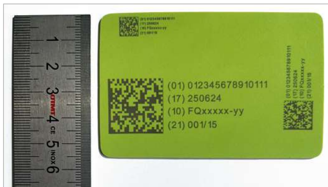
Exemple de tailles de gravure laser sur silicone (avec un QR Code à scanner pour tester sa lisibilité).
