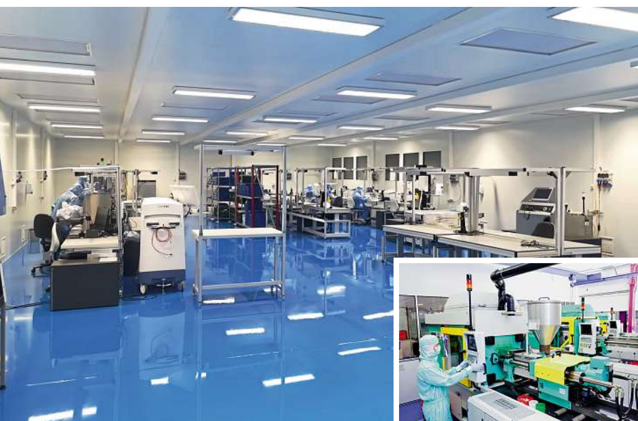
Les salles blanches ISO 7 de Mecaplast Swiss, dédiées respectivement à l'assemblage (image principale) et à l'injection (image dans l'angle)
