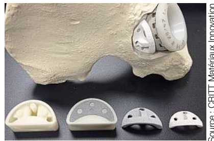
Figure 2a - Pièces de démonstration inspirées du système de révision acétabulaire Trabecular Metal de Zimmer.
