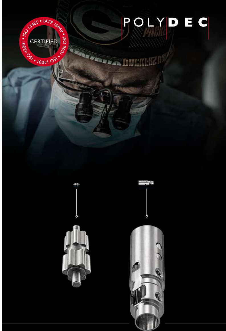
Pièce en inox 316L usinée puis polie en tribofinition haute énergie voie sèche (Ra 0,022 microns).
