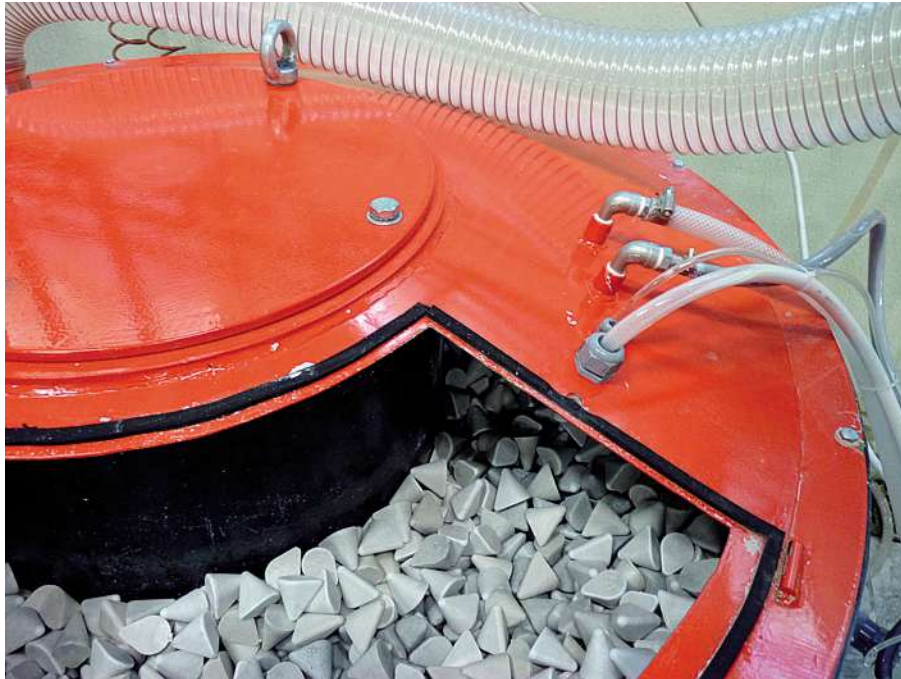
Illustration 2 : Bac d'une unité de tribofinition contenant des médias QF, avec la tuyauterie d'alimentation automatique des composés en gel Microfluid
