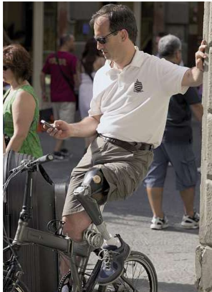
Illustration : Sur le long terme, la capacité de la prothèse à réagir intelligemment évite des signes d'usure précoces aux autres articulations et assure une meilleure santé au patient.
