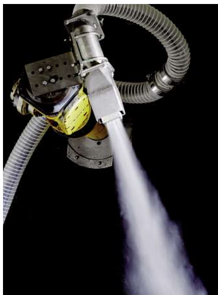
Illustration : L'efficacité du nettoyage est basée sur l'action conjointe de la vapeur saturée et d'un courant d'air à grande vitesse
