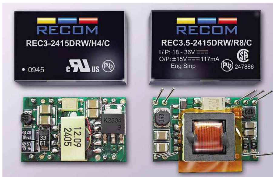
Illustration : Comparaison visuelle du REC3.5 (à droite) avec isolation jusqu'à 10kVDC et le modèle REC3 (à gauche) avec isolation simple destiné aux applications médicales.
