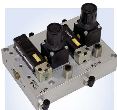
Illustration 2 : Le module avertisseur de gaz intègre deux fonctions primaires : émettre un signal sonore si la pression descend au-dessous d'un seuil prédéfini et intervenir en cas de panne de gaz
